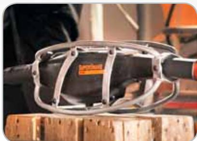
Прочная стальная рама обеспечивает эффективную защиту механизма SuperSnake от таких источников опасности на рабочем месте, как удары и падения.
