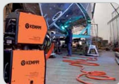
Механизированные сварочные горелки и приводные горелки традиционной конструкции увеличивают массу и нагрузку на руку сварщика. Кроме того, они имеют небольшой радиус действия, ограниченные возможности использования разных типов присадочной проволоки или объема выполнения сварочных операций. SuperSnake GT02S решает эти проблемы, одновременно уменьшая массу и нагрузку на руку сварщика за счет использования стандартных сварочных горелок.
