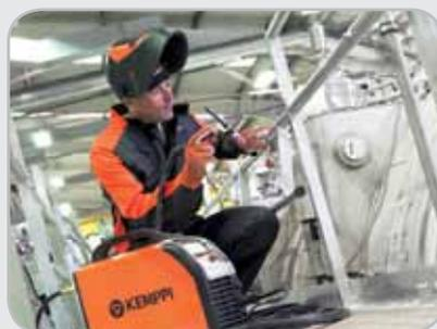
Оборудование MasterTig MLS обладает малой массой и компактными размерами, но, в то же время, обеспечивает высокий сварочный ток и показатели рабочего цикла.
